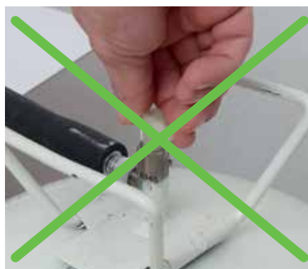
03 ATTENTION NE JAMAIS fermer le robinet du canister. Le flexible doit toujours rester sous pression.
